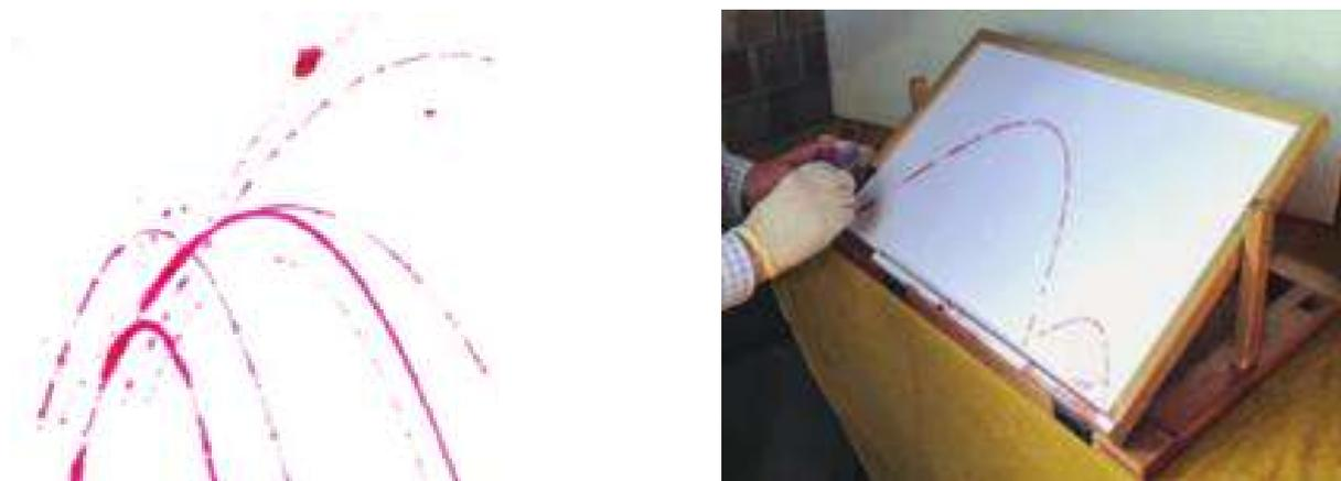
Fig. 1.5: Riproduzione in laboratorio dell’esperimento di Guidobaldo e Galileo (figura tratta da Cerreta, 2019)
