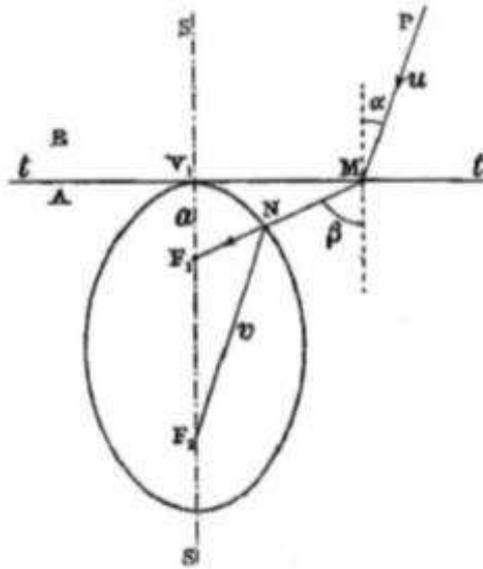
Fig. 1.3: Ellissoide di rotazione con analogia tra riflessione e rifrazione
