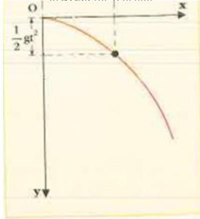
Figura 20. Un grave lanciato orizzontalmente descrive una traiettoria parabolica con asse verticale.
