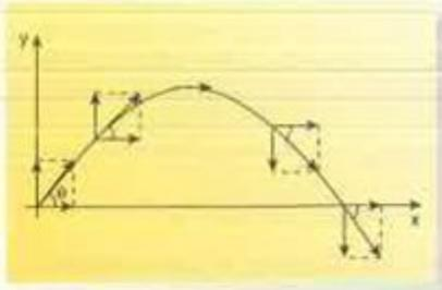
**Fig. 3.33** Traiettoria di un proiettile sparato in una direzione formante un angolo  $\theta$  con l'orizzontale. Si noti che la componente della velocità lungo  $x$  si mantiene costante.
